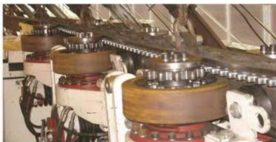
摩擦齿（小齿轮）驱动器，带有水平齿条的版本，放置在导轨上
