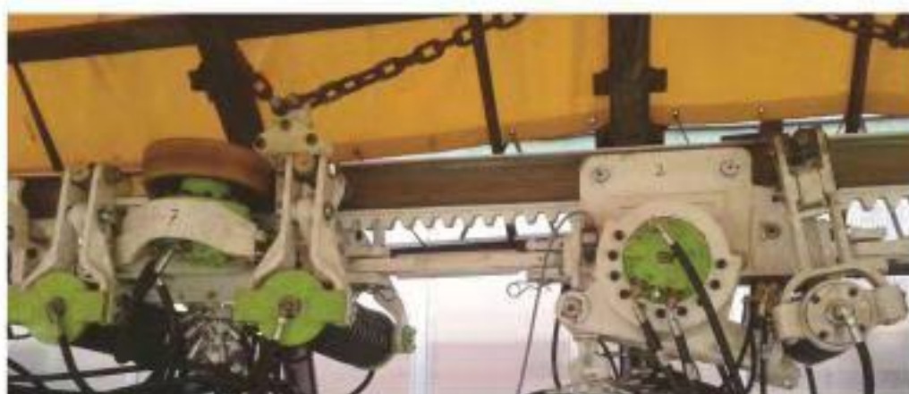
FMS机车的摩擦齿（小齿轮）驱动装置，齿条放置在导轨下方
