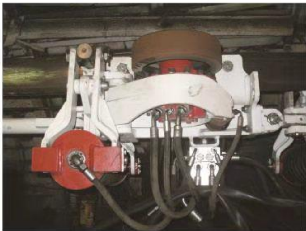
一个制动系统集成在驱动器托架上
