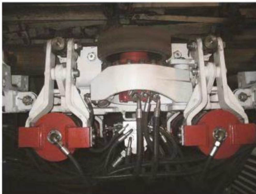
两个制动系统集成在驱动器托架上
